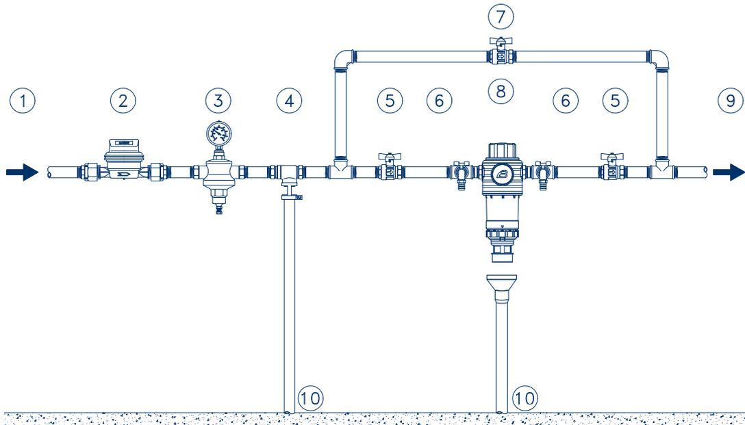
1. Ingresso acqua grezza; 2. Contatore generale; 3. Riduttore di pressione (eventuale); 4. Disconnettore (eventuale); 5. Valvola di intercettazione; 6. Rubinetto preleva-campione; 7. Valvola by-pass; 8. Filtro; 9. Uscita acqua trattata; 10. Scarico.
